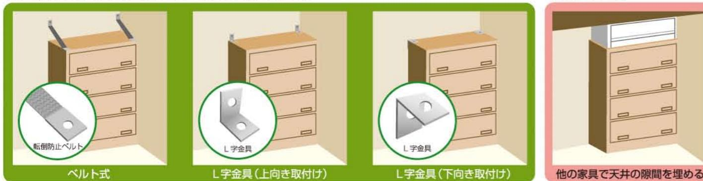
ベルト式 L字金具(上向き取付け) L字金具(下向き取付け)
